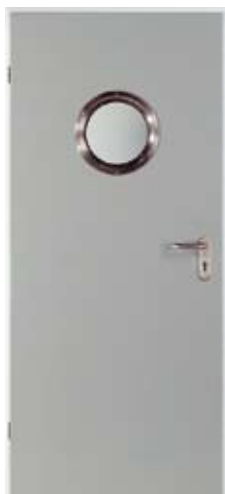
Врата ZK/OIT Остъкляване с кръгла форма шир. 300, или 400 мм. Рамка на стъклото от алуминий, елоксирана в естествен тон (E6/EV1), по желание от неръждаема стомана (Изображение).
